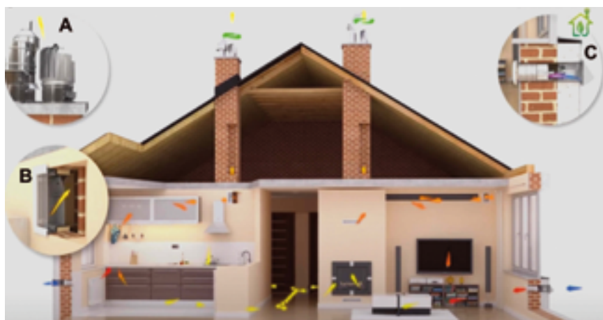
Rys. 2. System wspomagania wentylacji grawitacyjnej domu jednorodzinnego [7]
