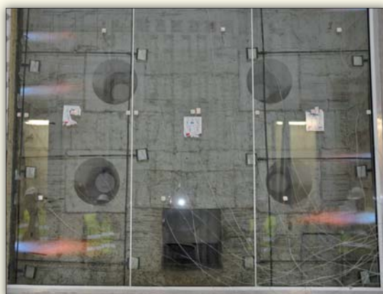
Fot. 2 | Ściana przeszklona od strony nienagrzewanej w momencie rozpoczęcia badania (widoczne płomienie palników)
