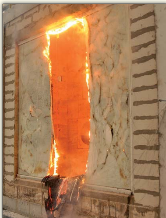
Fot. 3 | Ściana przeszklona od strony nienagrzewanej po badaniu
