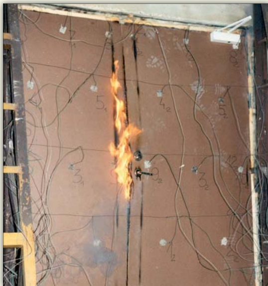
Fot. 8 | Płomień ciągnie się pomiędzy skrzydłami drewnianych drzwi dwuskrzydłowych
