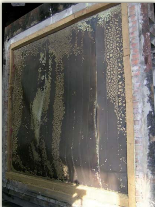
Fot. 4 | Ściana z płyt warstwowych od strony nagrzewanej po badaniu
